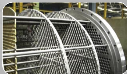
«Гибридное» решение EMbaffle® для защиты от вибрации, применяемое в теплообменниках с традиционной перегородкой
