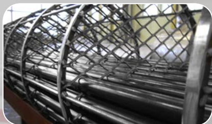
Образец находящегося в производстве 18-метрового компактного теплообменника «газ-газ» EMbaffle®
