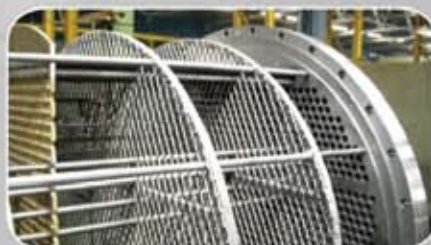
“Hybrid” EMbaffle 熱交換器 (振動防止対策のため従来型baffleとの組合せ)
