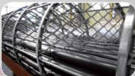
製作中の18m長 Compact EMbaffle (ガス/ガス熱交換器)
